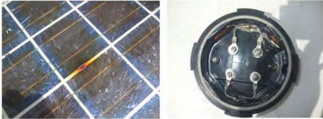
Gambar 4.2: Kerosakan pada Panel Solar dan Diod (Sumber Penyelidik)
